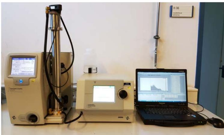
**Abbildung 5:** SMPS<sup>TM</sup>-Gerat (Scanning Mobility Particle Sizer) Hersteller TSI. Quelle SBS
