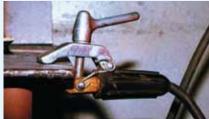
Ordentlicher Masseanschluss der Werkstückauflage
