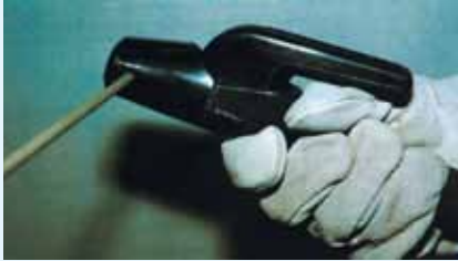
Voll isolierter Elektrodenhalter und Elektroschweißerhandschuh
