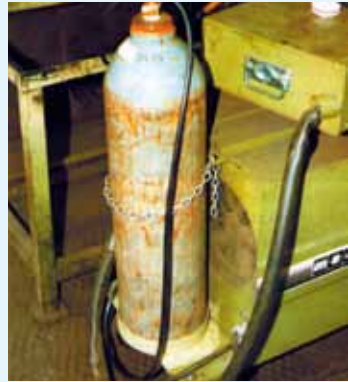
Schutzgasschweißgerät mit sicher befestigter Schutzgasflasche
