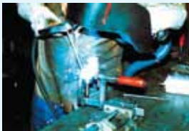
Im Schweißerschutzschirm integrierte Absaugung
