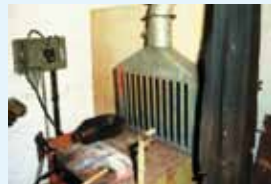
Schweißstisch mit integrierter Absaugung
