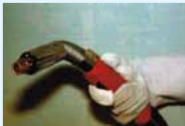
Schutzgasschweißpistole mit integrierter Absaugung
