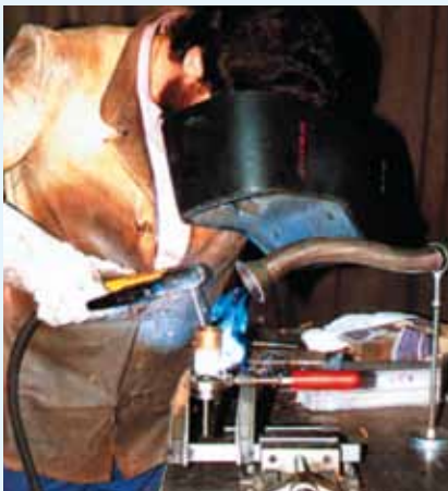
Absaugungen, bei denen der Schweißrauch direkt an der Entstehungsstelle abgesaugt wird
