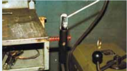
Voll isolierte Aufhängung des Elektrodenhalters
