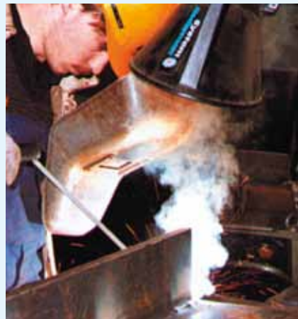
Absaugungen, bei denen der Schweißrauch direkt an der Entstehungsstelle abgesaugt wird
