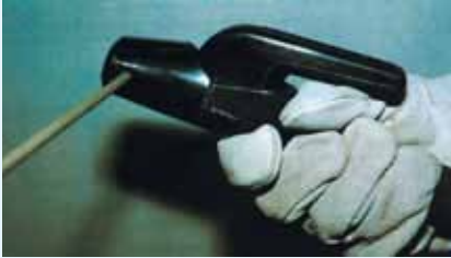
Voll isolierter Elektrodenhalter und Elektroschweißerhandschuh
