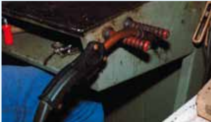
Voll isolierte Aufhängung der Schweißpistole
