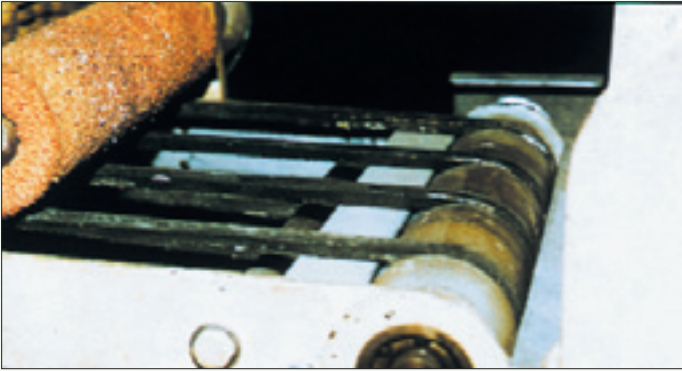
Auch ein Transportkeilriemen ist wie ein Förderband zu sichern
