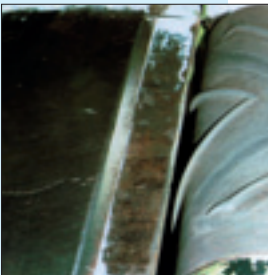
Eine bewegliche Schutzleiste, die im Gefahrenfall das Förderband über einen Endschalter stillsetzt
