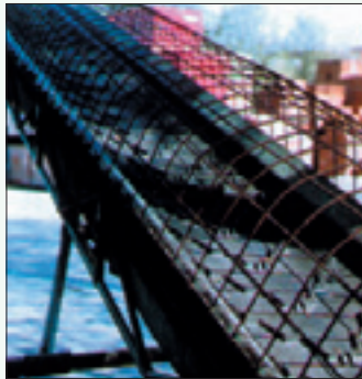
Schutzgitter an einem Band für große Stückkohle
