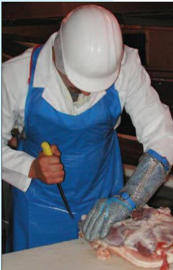
*Gefahr für die das Material führende Hand und für den Bauchraum, wenn keine Schutzausrüstung verwendet wird*
