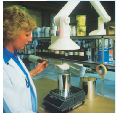
Punktabsauger im Chemielabor
