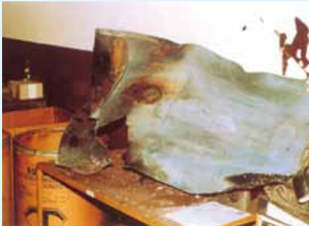
Reste einer Azetylenflasche, die durch eine Azetylenzersetzung zerstört wurde
