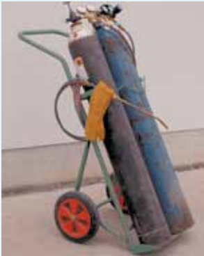
Flaschentransportwagen, mit dem die Gasflaschen im angeschlossenen Zustand transportiert werden dürfen
