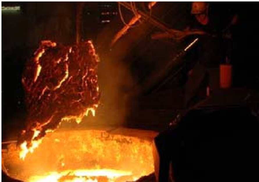
Abb. 16: Abschlacken bei einem Schmelzofen in einer Eisengießerei.
