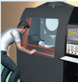
Rang 2 - Trennende Schutzeinrichtung
