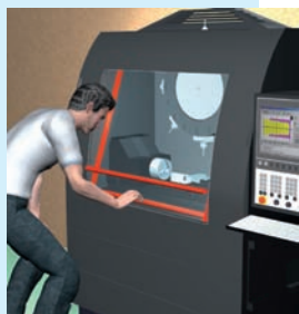
Rang 2 - Trennende Schutzeinrichtung
