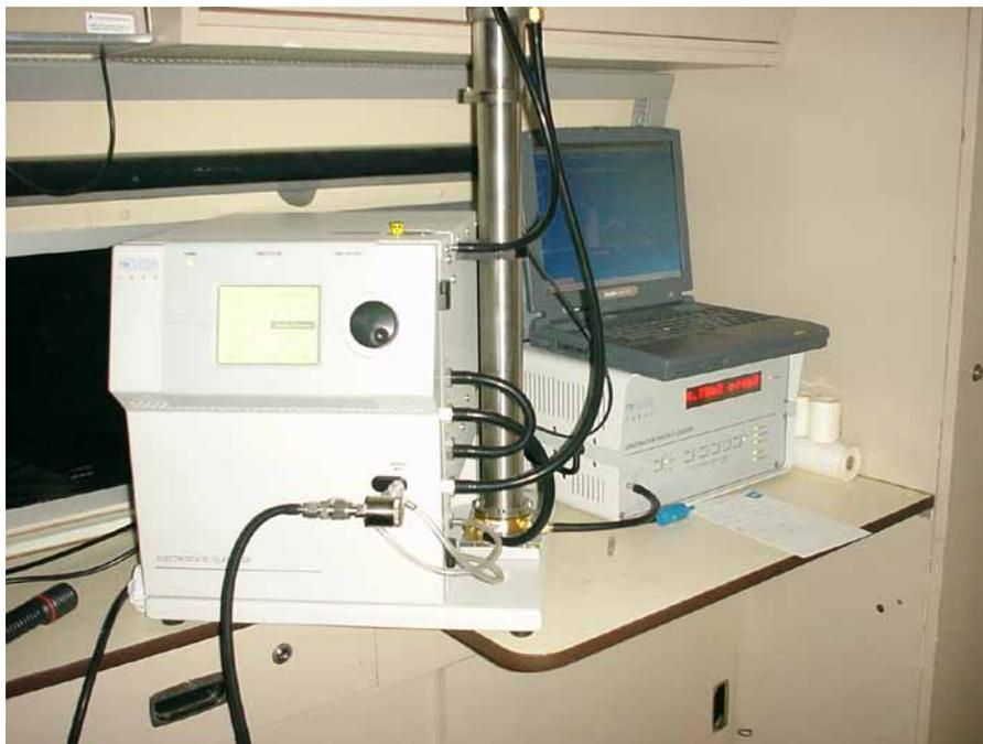
**Abbildung 5:** SMPST<sup>TM</sup> -Gerät (Scanning Mobility Particle Sizer) der Firma TSI.
