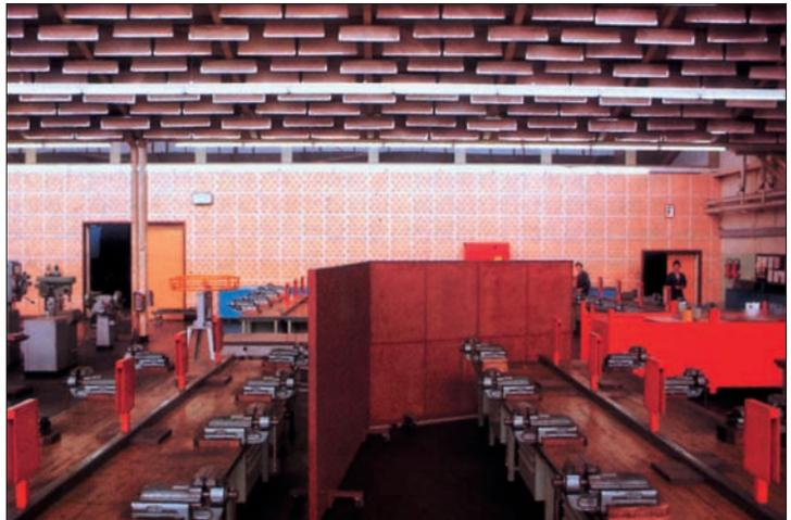
*Schallschirme sollen die Ausbreitung von Lärm verhindern. Sie kommen nur bei schallschluckender Ausführung der Decke (und eventuell der Wände) voll zur Wirkung*
