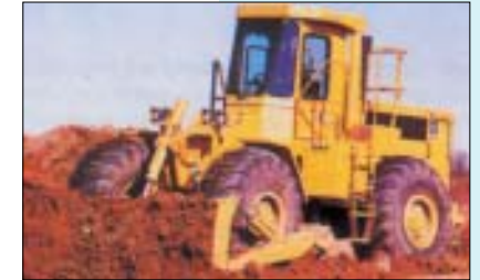
Überrollschutzaufbau bei einem Radlader mit Planiereinrichtung
