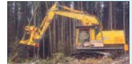
Schutzaufbauten gegen herabfallende Gegenstände
