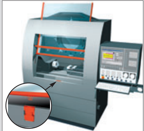
Beweglich trennende Schutzeinrichtung und Verriegelung als Detail (Ansicht von Innen)
