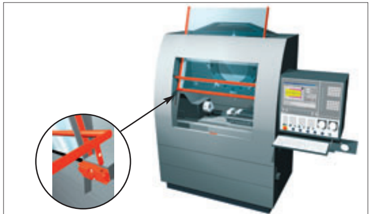
Beweglich trennende Schutzeinrichtung und Zuhaltung als Detail (Ansicht von innen)
