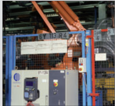
Roboter mit trennender Schutzeinrichtung und verriegelter Schutztür, (Quelle: Firma Sick GmbH)
