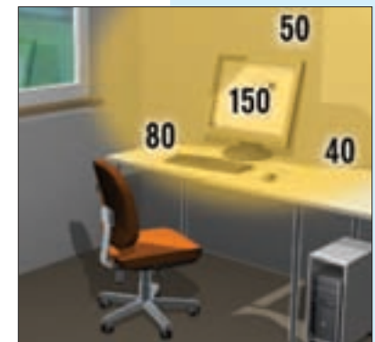
Zulässige Unterschiede der Flächenhelligkeiten bei richtiger Bildschirmaufstellung (Die Zahlenwerte geben Leuchtdichten in cd/m^2 an.)
