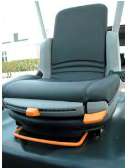
Ergonomisch gestalteter Fahrersitz mit Gurt
