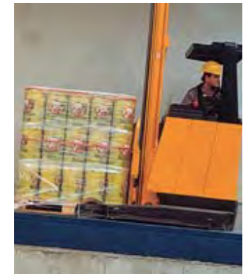
Die Last wird bergseitig geführt
