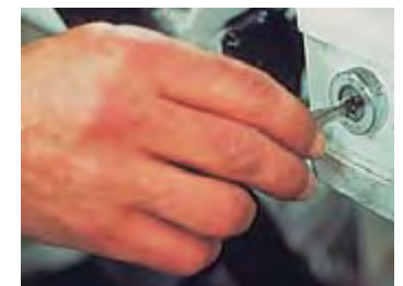
Sicherung gegen unbefugte Inbetriebnahme durch Abziehen des Schlüssels
