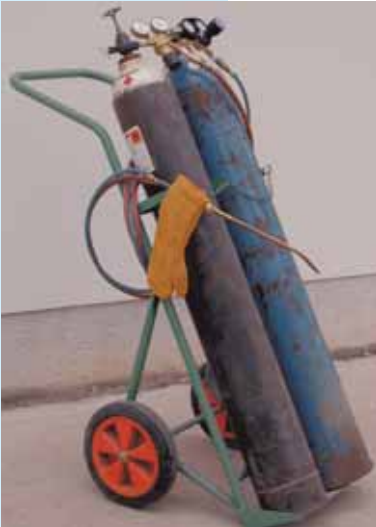
Flaschentransportwagen, mit dem die Gasflaschen im angeschlossenen Zustand transportiert werden dürfen
