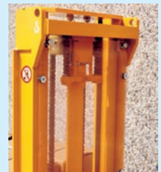
Durchsichtige Verdeckung der Gefahrenstellen
