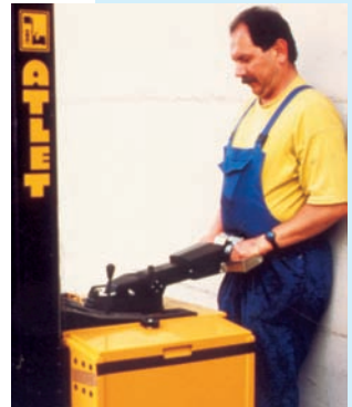
Der Sicherheitsumschalter bewirkt Fahrtrichtungsumkehr
