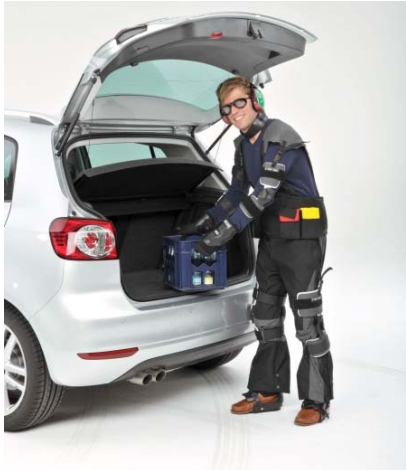
Abbildung 3. Einsatz von MAX in der Produktentwicklung und Arbeitsplatzgestaltung bei Volkswagen.
