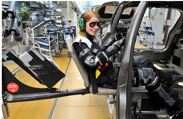
Abbildung 3. Einsatz von MAX in der Produktentwicklung und Arbeitsplatzgestaltung bei Volkswagen.
