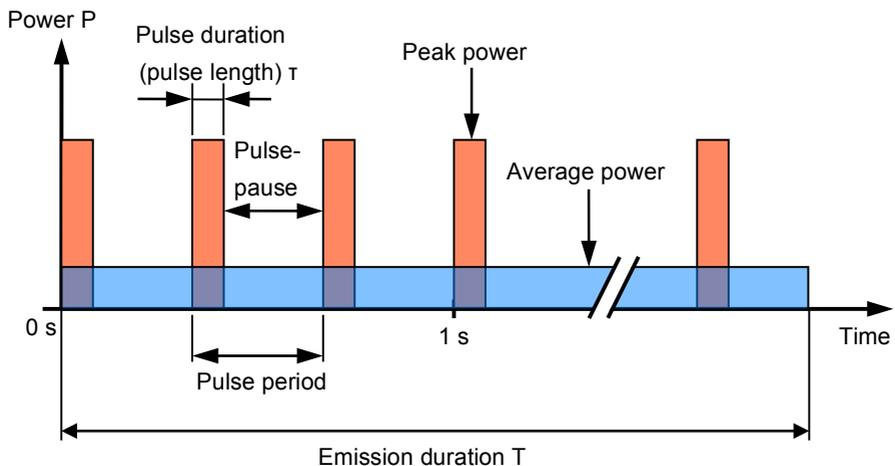
Fig. 5: Pulse parameters
