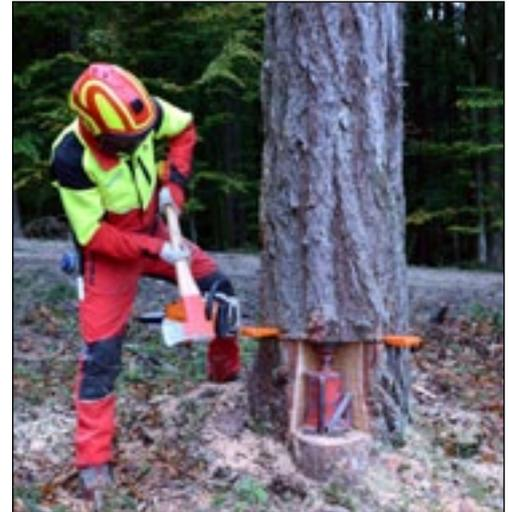
Der **hydraulische Fällkeil** ist auch eine Hilfe beim Fällen.
