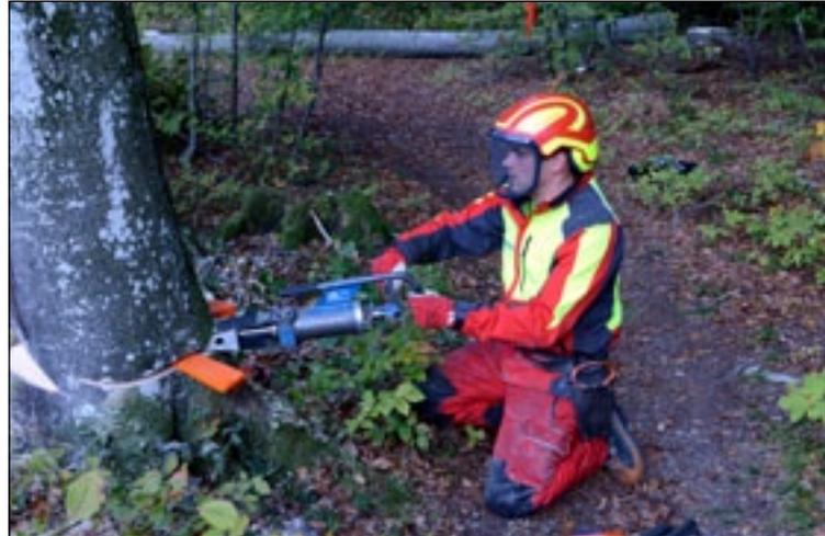
Ein **Zuggerät** ist ein Gerät, mit dem der Baumstamm in eine Richtung gezogen werden kann.
