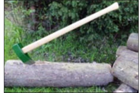
Es gibt auch die **Spalt-Axt**. Sie heißt auch **Mösel-Hacke**. Die Spalt-Axt wiegt ungefähr 2,5 Kilogramm und kann wie der Spalt-Hammer verwendet werden.
