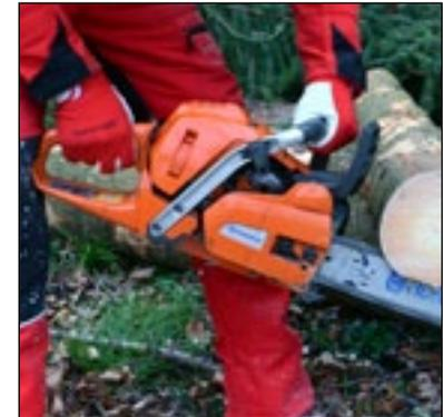
Stützen Sie die Motorsäge am Baumstamm ab und den hinteren Teil der Motorsäge am eigenen Körper. So können Sie das Gewicht und den Druck der Motorsäge ausgleichen.
