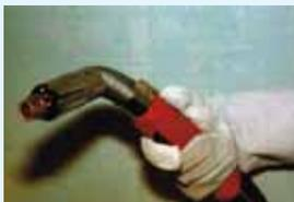
*Schutzgasschweißpistole mit integrierter Absaugung*
