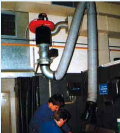
*Schweißplatz mit Absaugung und Abführung der gereinigten Abluft ins Freie. Die Arbeiter sollten natürlich nur mit ausreichender Schutzkleidung und -ausrüstung arbeiten!*
