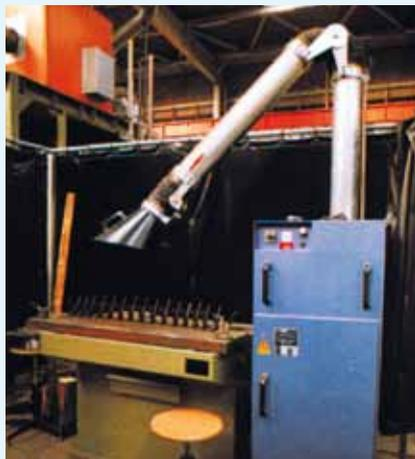
*Schweißplatz mit Absaugung, bei der die abgesaugte Luft gereinigt zurückgeführt wird*
