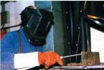
*Schlacke entfernen mit einem selbstabdunkelnden Schweißerschutzschirm*
