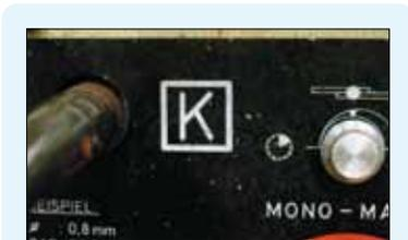
*Schweißgleichrichter, der für die Verwendung unter erhöhter elektrischer Gefährdung geeignet und gekennzeichnet ist*
