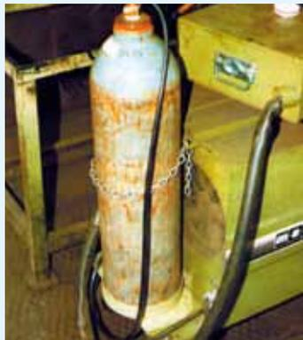
*Schutzgasschweißgerät mit sicher befestigter Schutzgasflasche*
