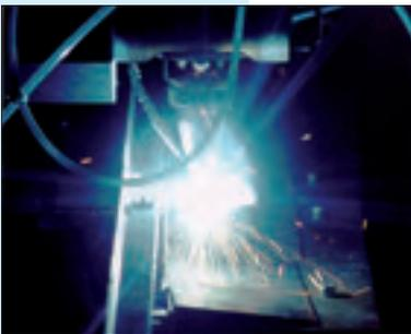
*Beispiel einer Anwendung mit möglicher UV-Strahlenbelastung (Laserschweißen)*
